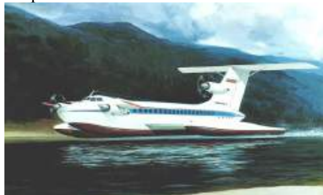
Рис.17. Проект речного экраноплана «Ракета-2»
