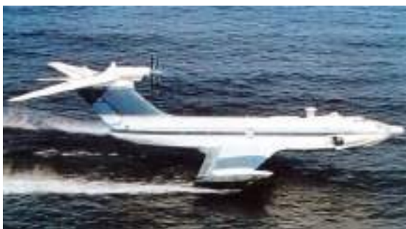
Рис. 13. Экраноплан «Орленок». Нижний Новгород. Полная масса 140т, ПН-20т. Высота полета на экране 2-10м Крейсерская скорость 350км/ч
