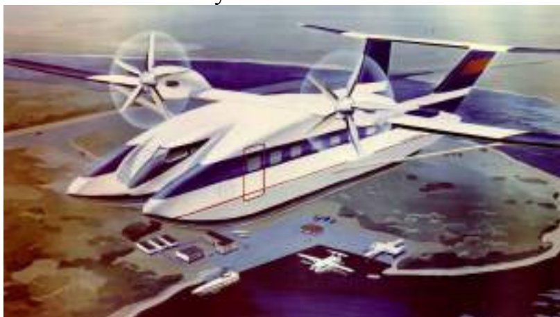
Рис. 25. Проект пассажирского самолета с шасси на воздушной подушке для местных авиалиний.
