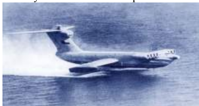
Рис. 14. Экраноплан «Спасатель». Нижний Новгород. Полная масса 400т Высота полета на экране 2,5-10м Крейсерская скорость 450км/ч
