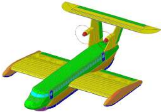
Рис.18. Проект речного экраноплана нового поколения с шасси на воздушной подушке.
