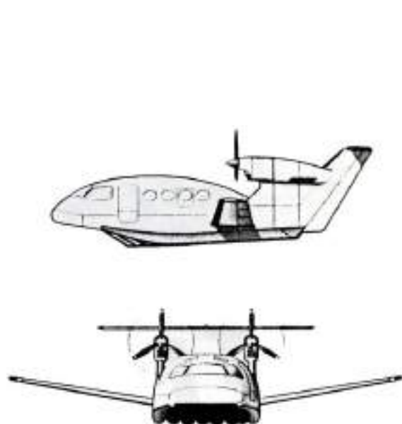
Рис. 23. Проект многоцелевого экранолета с шасси на воздушной подушке С-90. ОКБ Сухого.
