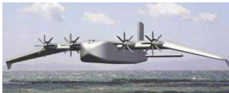
Рис.29. Пеликан – Очень Большой Самолет Взлетный вес- 2700 т. Габариты: 120 х 150 х 30 м.
